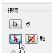
16. モデルのエッジを選択します。矢印が内側を向いている場合は軸方向切り替えのアイコンをクリックして外側に向けます。
